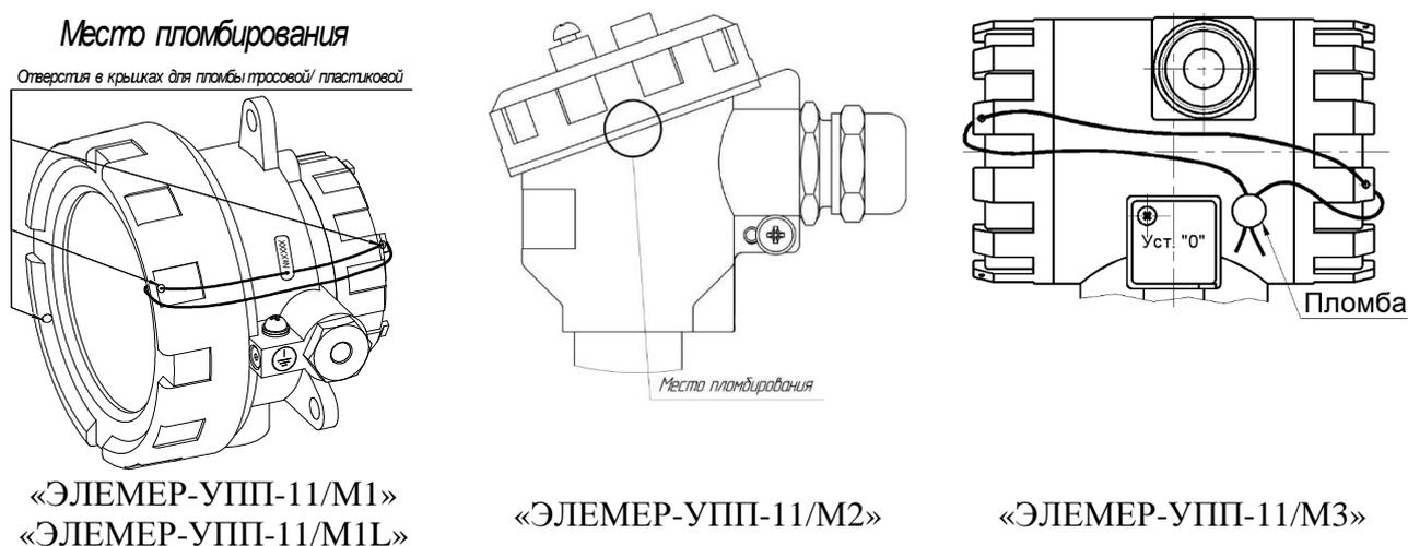
Рисунок 4 – Схема пломбировки от несанкционированного доступа
