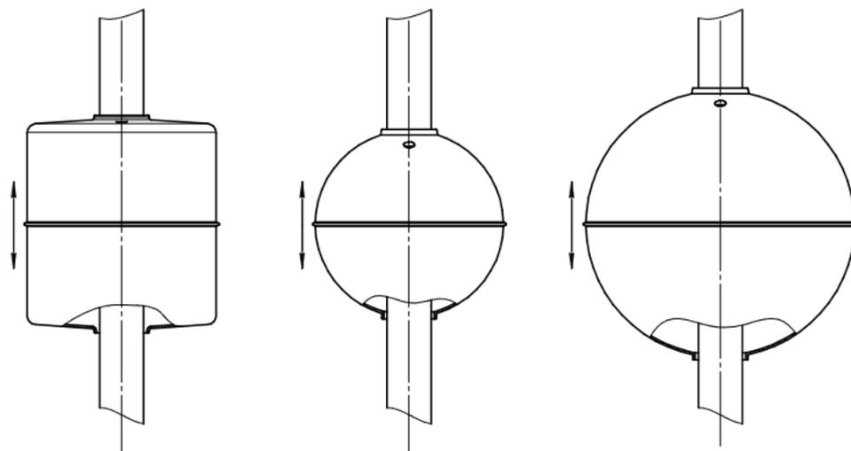
Рисунок 3 - Типы поплавков
