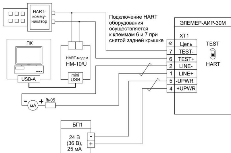
**Рисунок 3.11** - Схема электрическая подключений ЭЛЕМЕР-AИР-30М с выходным сигналом 0-5 мА без каналов сигнализации с кабельным вводом
