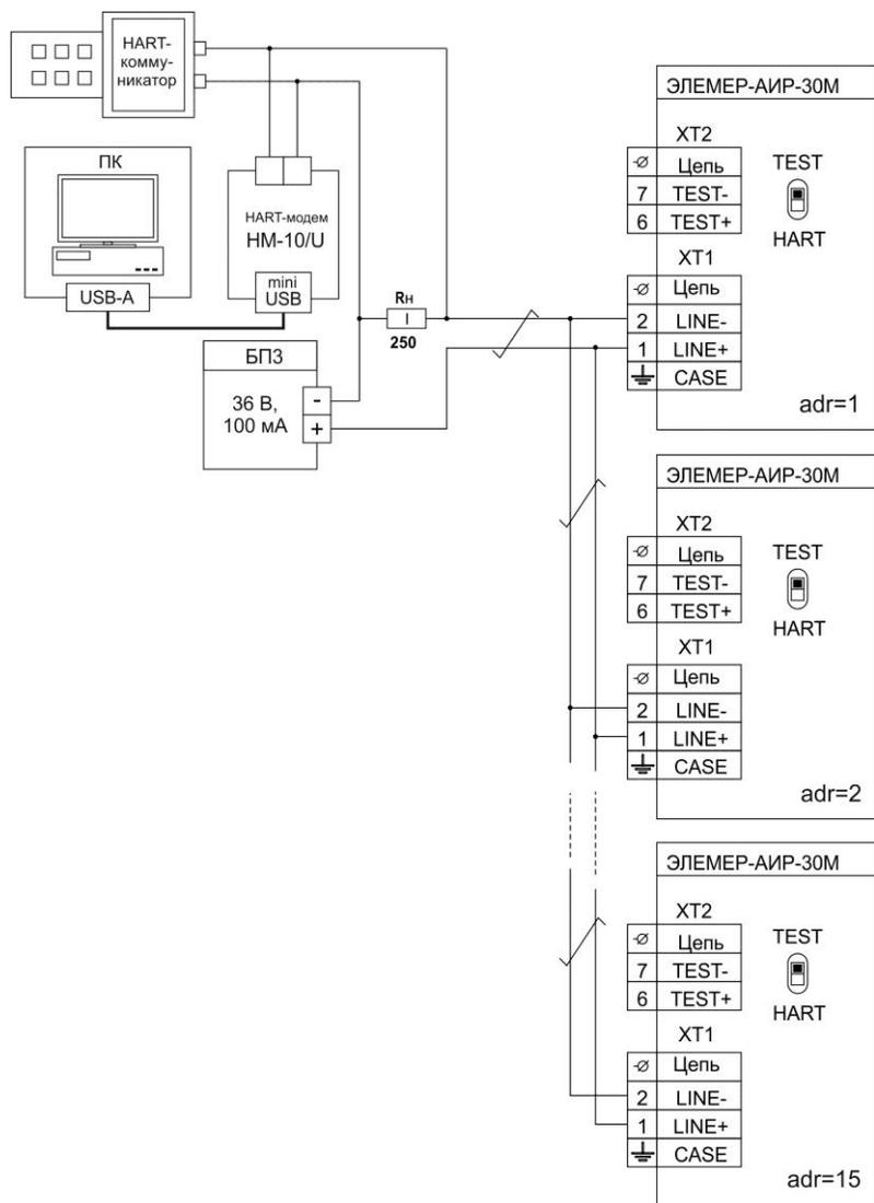
**Рисунок 3.25** - Схема электрическая подключений ЭЛЕМЕР-АИР-30М с выходным сигналом 4-20 мА с кабельным вводом при многоточечном режиме работы по HART-протоколу (каналы сигнализации не показаны, но могут присутствовать)
