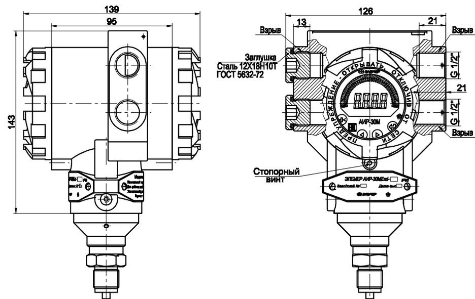
Рисунок А.10 - Чертеж средств взрывозащиты
