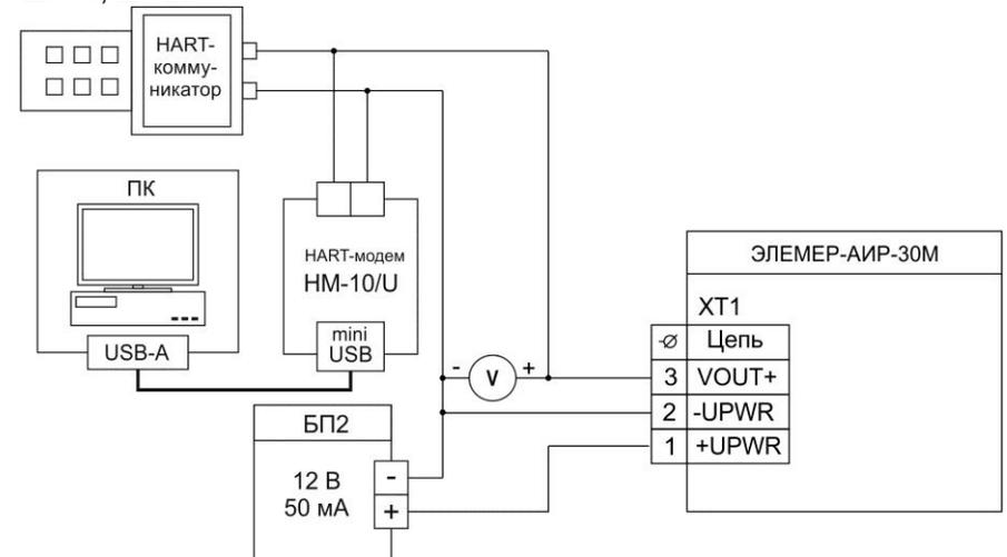
**Рисунок 3.9** - Схема электрическая подключений ЭЛЕМЕР-АИР-30М с выходными сигналами по напряжению 0,8-3,2 В; 0,5-4,5 В; 1-5 В с кабельным вводом
