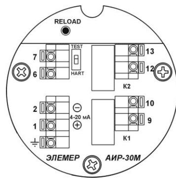
**Рисунок 2.5** - Модуль подключений АИР-30М с выходным сигналом 4-20 мА и электромагнитными (поляризованными) реле
