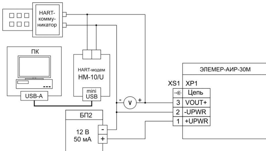
**Рисунок 3.10** - Схема электрическая подключений ЭЛЕМЕР-AИР-30М с выходными сигналами по напряжению 0,8-3,2 В; 0,5-4,5 В; 1-5 В с разъемами ШР14, ШР22
