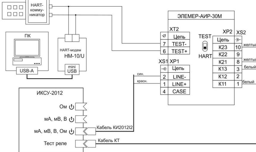
**Рисунок 3.2.1** - Схема электрическая подключений ЭЛЕМЕР-АИР-30М с выходным сигналом 4-20 мА с каналами сигнализации на оптореле с разъемами ШР-14, ШР-22 к ИКСУ-2012
