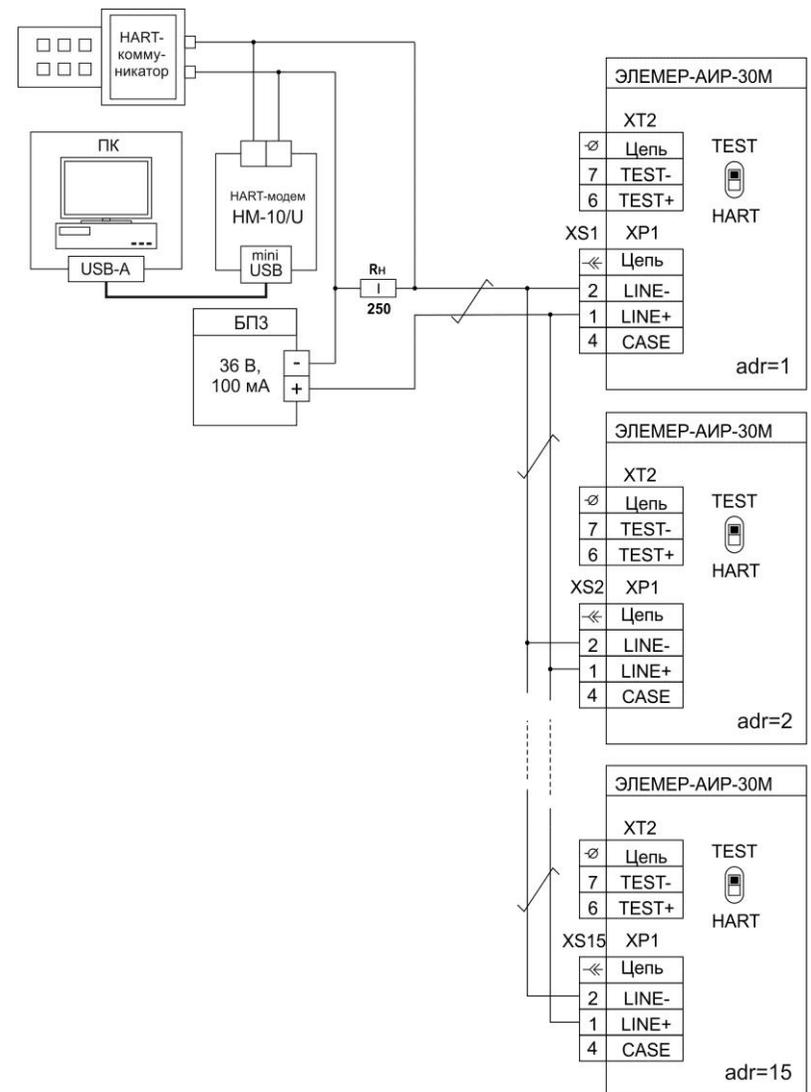
**Рисунок 3.26** - Схема электрическая подключений ЭЛЕМЕР-АИР-30М с выходным сигналом 4-20 мА с разъемом ШР-14, ШР-22 при многоточечном режиме работы по HART-протоколу (каналы сигнализации не показаны, но могут присутствовать)
