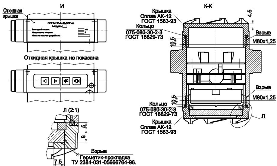
Рисунок А.11 - Чертеж средств взрывозащиты
