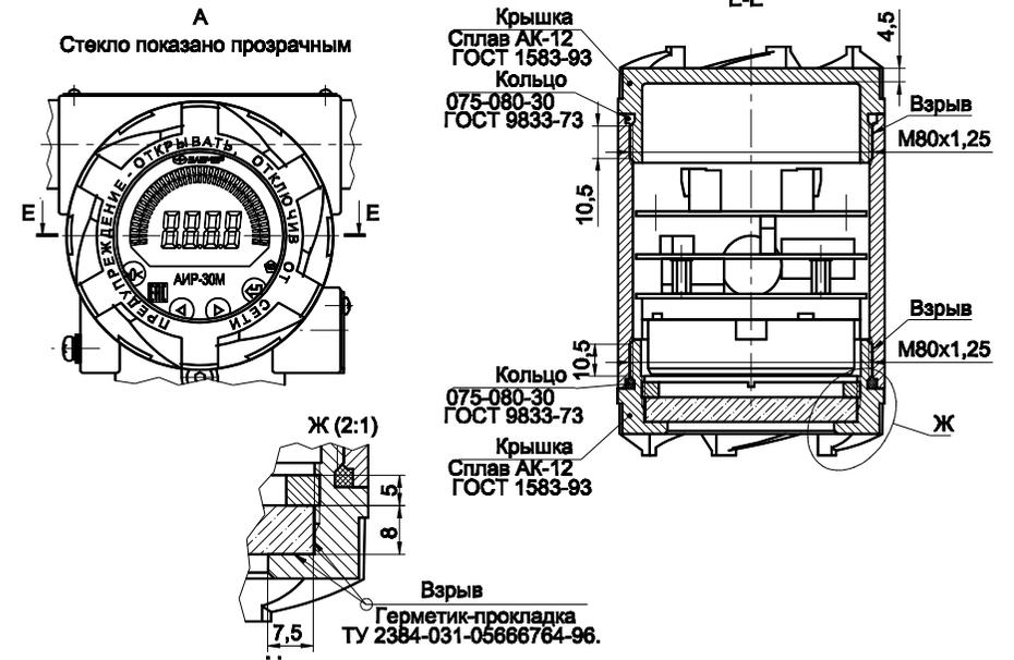
Рисунок А.8 - Чертеж средств взрывозащиты
