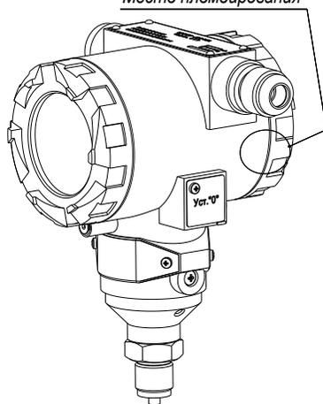
Рисунок А.15 – Место пломбирования АИР-30М
