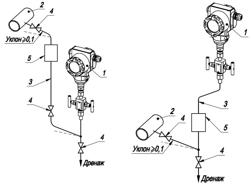
а) плотность разделительной жидкости больше плотности измеряемой среды
