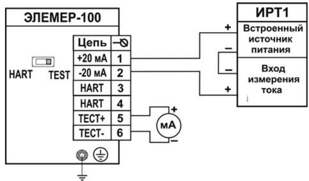
ЭЛЕМЕР-100 (МП, МП1, МП2, МП3 с выходным сигналом 4...20 мА) с кабельным вводом к БПИ при обмене данными по HART-протоколу
