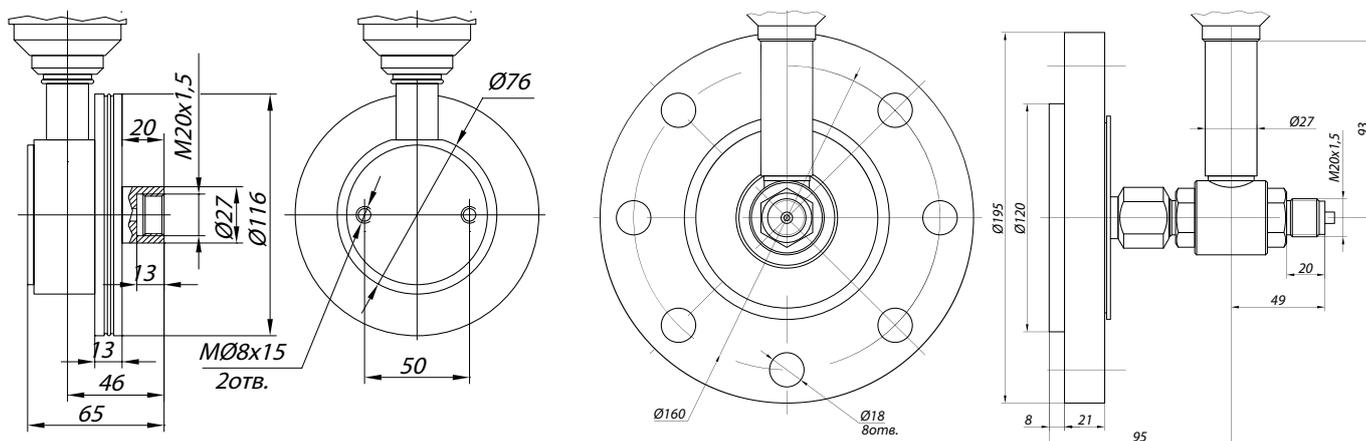
Габаритные и присоединительные размеры модуля сенсора (место Б) ЭЛЕМЕР-100, ЭЛЕМЕР-100Ех
