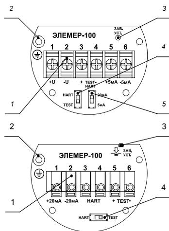
1 — винтовая или зажимная клеммная колодка для подключения токовых цепей, устройств, поддерживающих HART-протокол, и контроля тока 0...5 мА, 4...20 мА;
