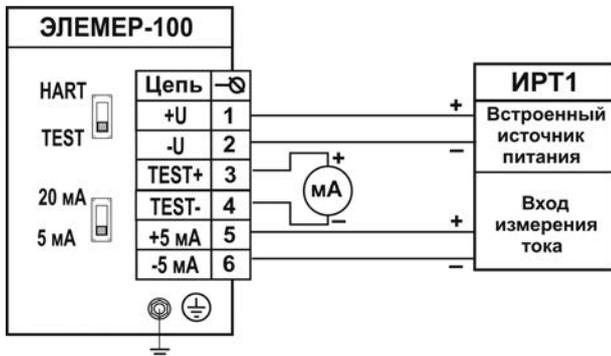
ЭЛЕМЕР-100 (МП, МП1, МП2, МП3 с выходным сигналом 4...20 мА) при обмене данными по HART-протоколу с использованием встроенного резистора нагрузки 250 Ом
