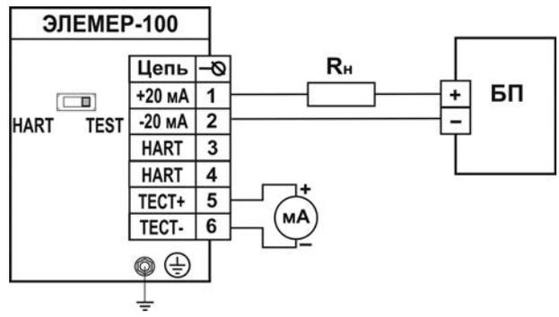
ЭЛЕМЕР-100 (МП, МП1, МП2, МП3 с выходным сигналом 4...20 мА) к разным приборам, с подключением миллиамперметра для контроля тока
