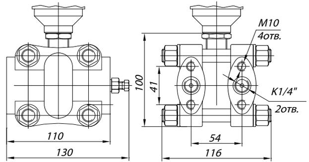
Габаритные и присоединительные размеры сенсоров ЭЛЕМЕР-100-ДД, ЭЛЕМЕР-100Ех-ДД, ЭЛЕМЕР-100Вн-ДД
