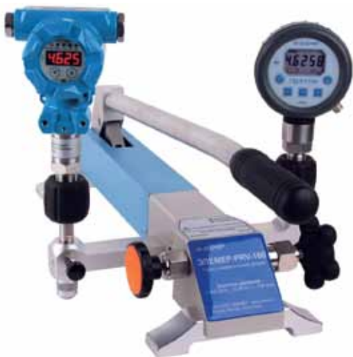
Поверка АИР-10SH на перегрузочную способность с эталонным манометром ПДЭ-010И. Р перегрузки = 500% ВПИ
