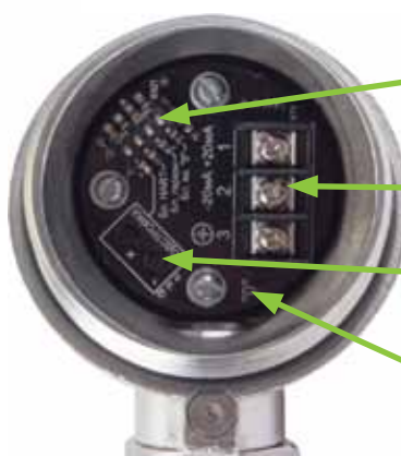
АИР-10SH в режиме установки «нуля» с помощью магнитного брелока
