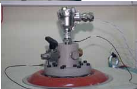
АИР-10SH на испытательном вибростенде (2000 Гц/ 10 г/ 0,75 мм)
