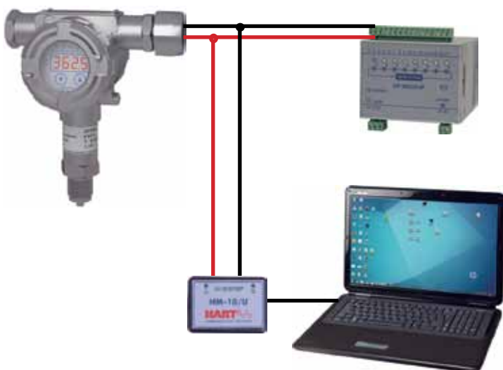
HART-модем HM-10U (интерфейс USB) для подключения к ПК
