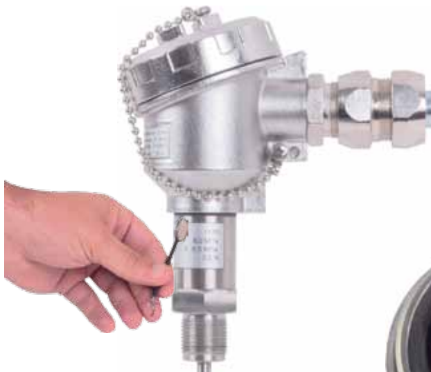
АИР-10SH в режиме установки «нуля» с помощью магнитного брелока
