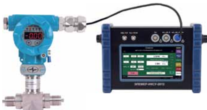
АИР-10SH с калибратором ЭЛЕМЕР-ИКСУ-2012 в режиме HART-коммуникатора
