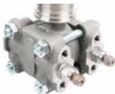
В датчиках AIP-20/M2-H штуцерного присоединения (ДИ, ДА, ДИВ) применены **современные сенсоры ведущих зарубежных производителей с металлической разделительной мембраной, изготовленные по технологии КНК (кремний на кремнии)** с высокой перегрузочной способностью **до 500%** от верхнего предела измерений.
