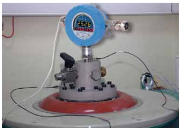
ЭКМ-2005 на испытательном вибростенде — 2000 Гц/ 10 g/ 0,75 мм
