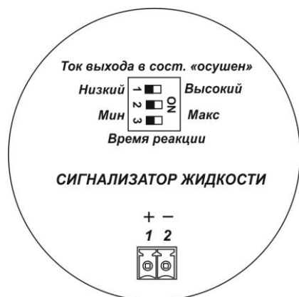
Рисунок 2.4 – DIP-переключатели на плате сигнализатора с кодом при заказе «N»
